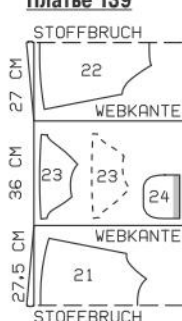
Планы раскладки при ширине трикотажного полотна 145 см
