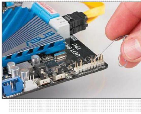
(если это сработает, значит, кнопка перезагрузки неисправна и должна оставаться отключенной). Если же это не поможет, отсоедините кнопку питания. Далее, если систему удастся запустить путем замыкания обоих контактов, например, при помощи скрепки, значит, неисправна кнопка питания. В данной ситуации подключите кнопку перезагрузки и используйте ее в дальнейшем как переключатель «ВКЛ/ВЫКЛ». В противном случае вам придется отнести системный блок в мастерскую на диагностику.
