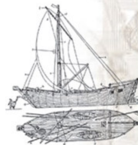
■ Русский коч, прообраз ледокола. Срезанная форма носовой оконечности позволяла легко затащить коч на лёд
