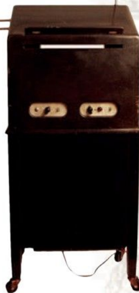
■ Классический терменвокс (1938). Левая антенна отвечает за громкость, правая — за высоту тона
