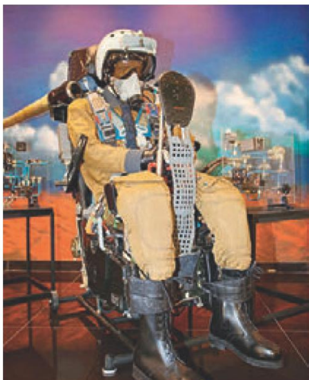
МАНЕКЕН В ЛЕТНОМ СНАРЯЖЕНИИ в катапультном кресле истребителя 5-го поколения. Хорошо видны выдвижной дефлектор, выполняющий функцию аэродинамической защиты летчика, опущенные ограничители разброса рук и раздвинутые стабилизирующие штанги.
