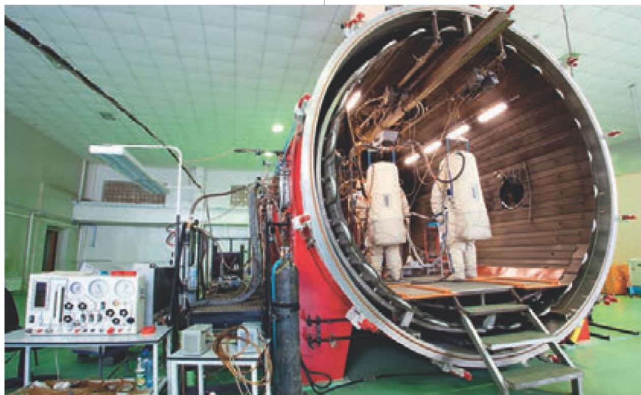
ТЕРМОБАРОКАМЕРА , в которой проходят испытания новейшие скафандры для МКС. На испытательной площадке «НПП «Звезда»» находится целый комплекс термобарокамер, в том числе и та, что использовалась для моделирования первого в истории выхода в открытый космос.
