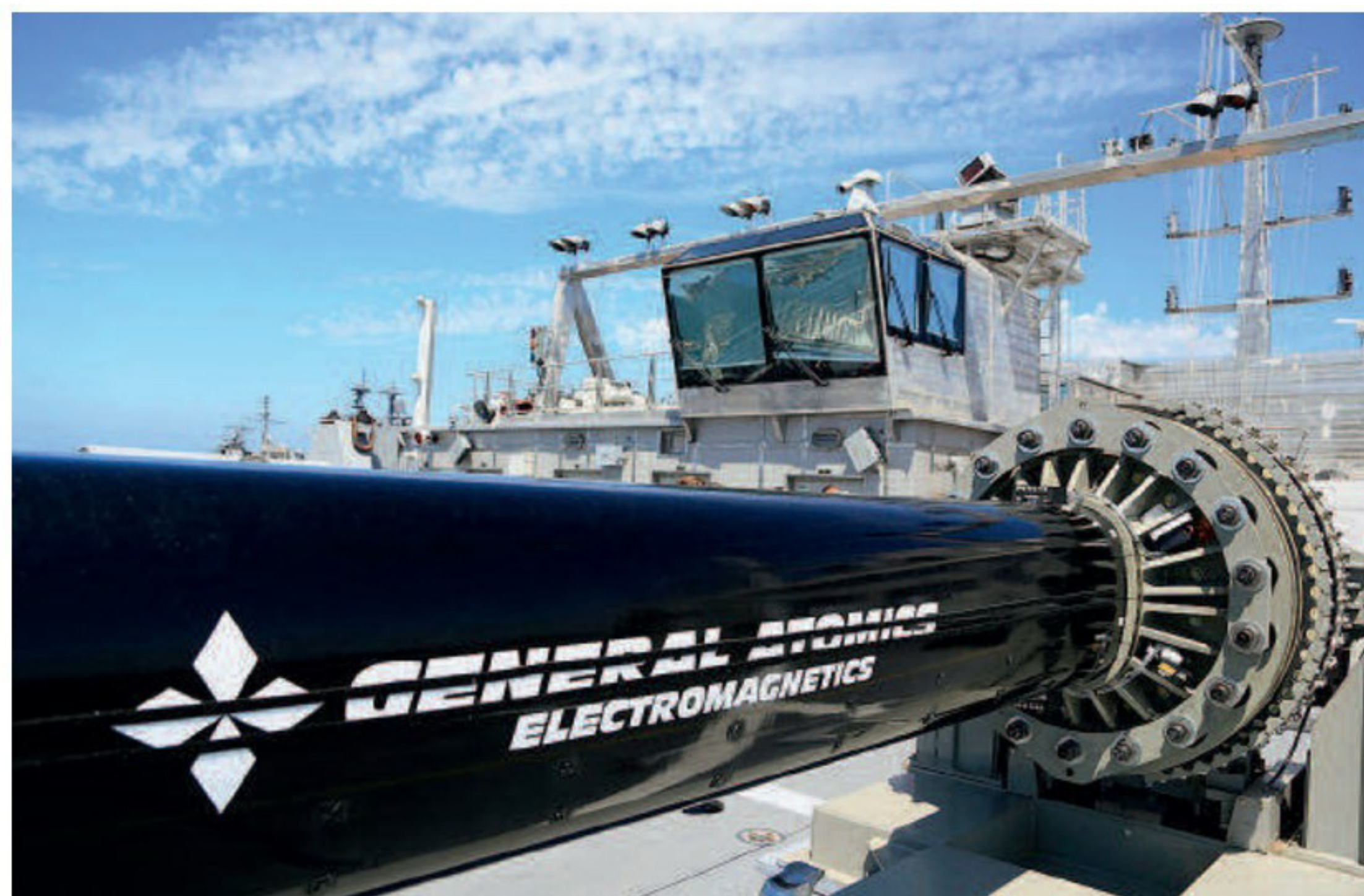
Рейлган Blitzer производства компании General Atomics (США) размещен на двух трейлерах – на одном собственно пушка, на другом – энергетическая установка. Разработка ЭМП началась в 2005 году и завершилась в 2011-м.
