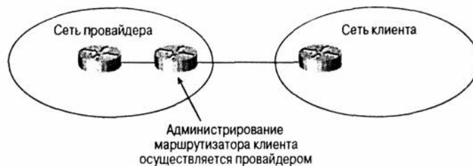
Рис. 2.12. Размещение маршрутизатора на технической площадке провайдера (пример)
