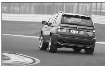
Рис. 2. Автомобиль с высоким центром тяжести склонен к опрокидыванию
