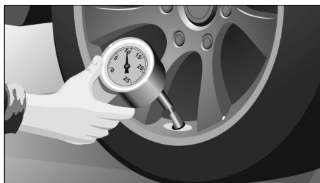
Рис. 11. Проверка давления в шинах манометром
