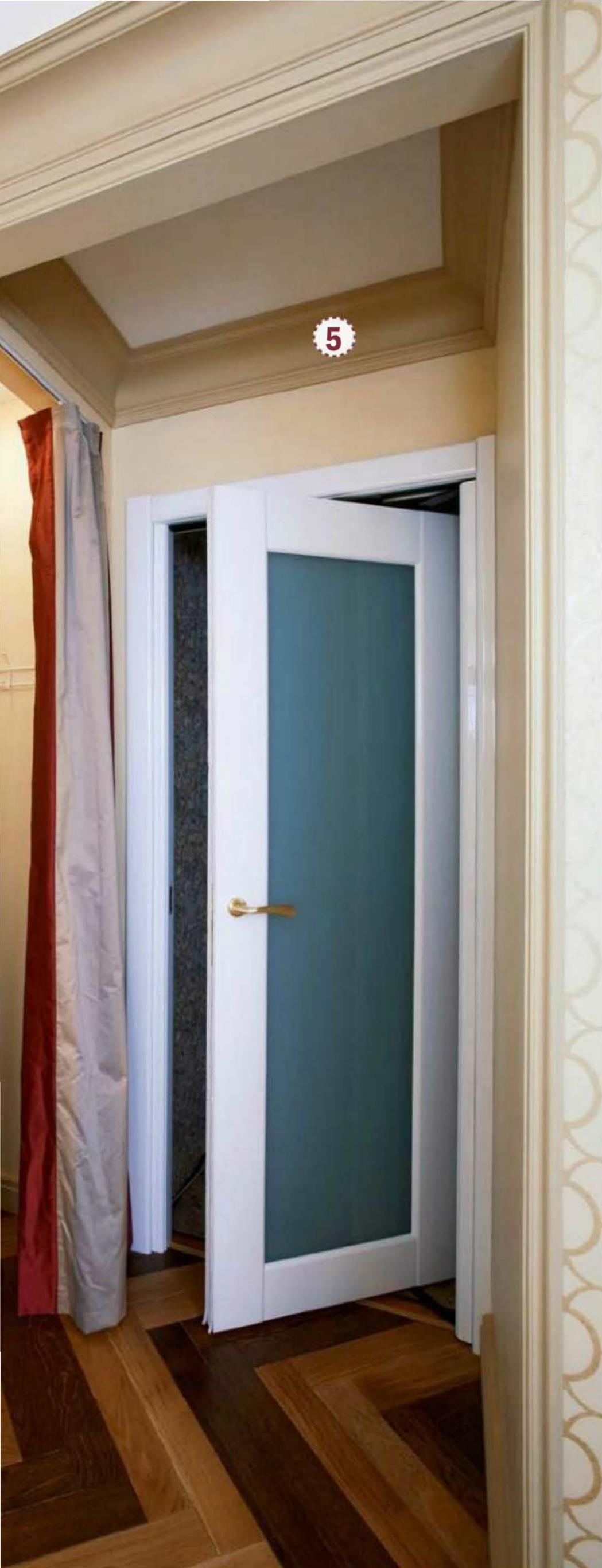
**5** Карниз, плинтусы и оформляющие входной портал молдинги выкрашены в цвет обоев, а сам портал сделан максимально высоким — все для того, чтобы визуально приподнять низкий (2,5 м) потолок.
