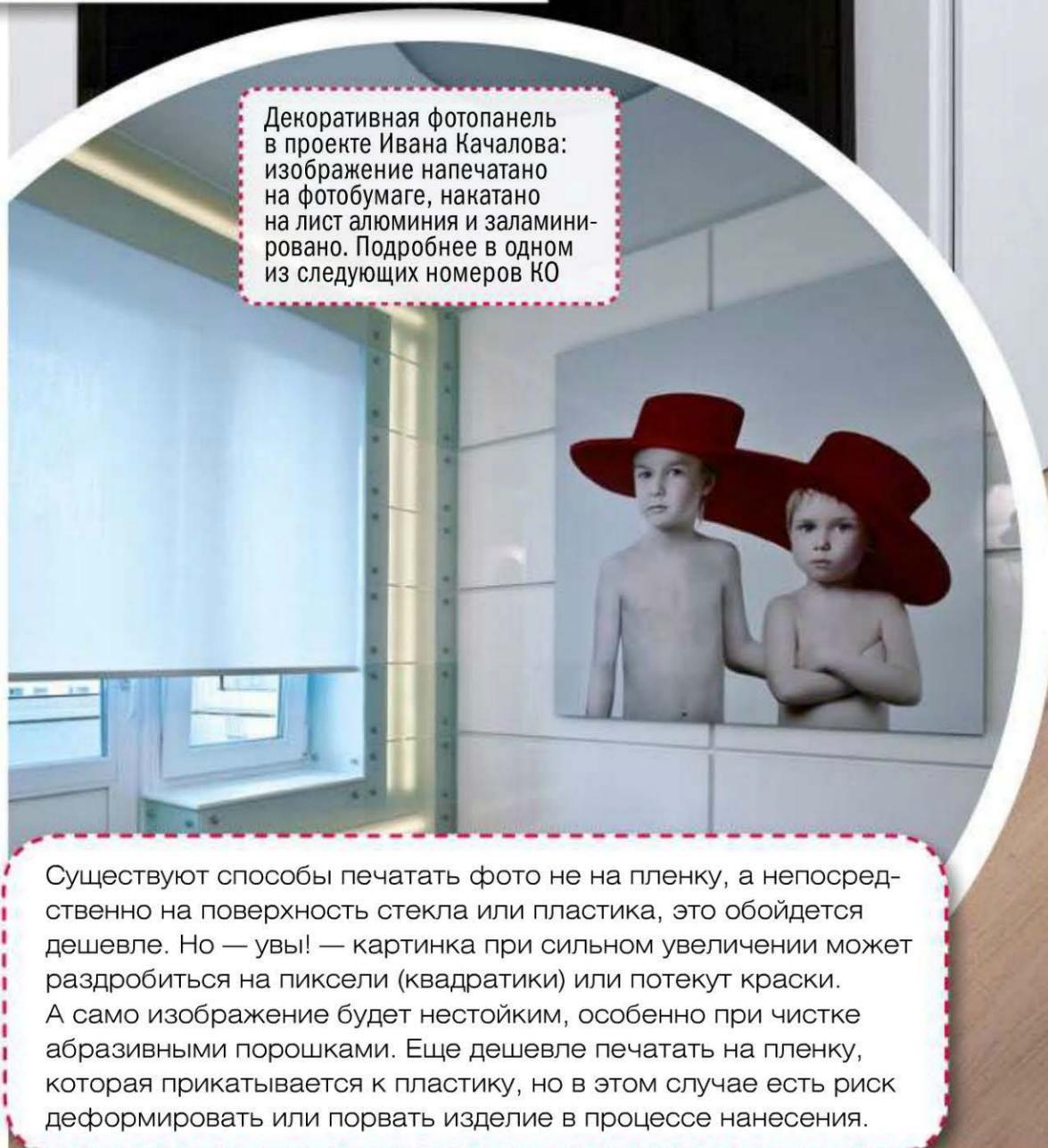
Декоративная фотопанель в проекте Ивана Качалова: изображение напечатано на фотобумаге, накатано на лист алюминия и заламинировано. Подробнее в одном из следующих номеров КО
