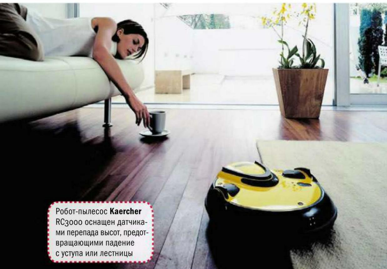
Робот-пылесос **Kaercher RC3000** оснащен датчиками перепада высот, предотвращающими падение с уступа или лестницы
