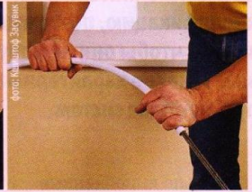
Пружина для гибки труб
