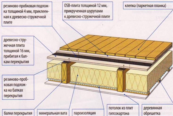
1 Порядок слоев пола, предложенный архитектором проекта
