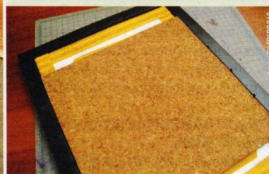
↑ Пробковая подложка является идеальным материалом под паркетную доску
