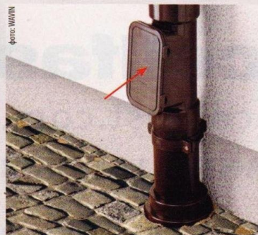
↑ Ревизия монтируется приблизительно на 0,3–0,8 м выше уровня земли
