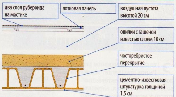
10 Совмещенная крыша с R = 1,18 м 2 ·К/Вт
