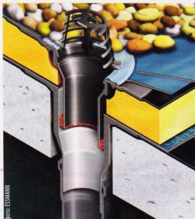
↑ Воронки на новых и модернизируемых крышах должны быть защищены листеуловителем...
