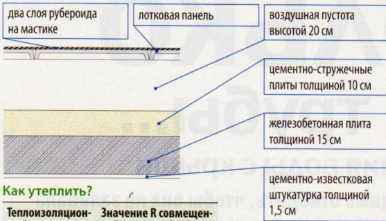
7 Совмещенная крыша с R = 1,09 м 2 ·К/Вт
