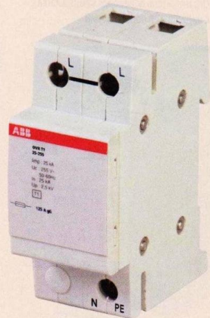
↑ Ограничитель перенапряжений класса В защищает оборудование от близкого удара молнии. Его устанавливают на входе главного распределительного щита
