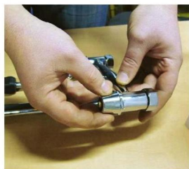
4 Снимают декоративную накладку
