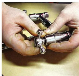
3 Демонтируют ручку изменения напора
