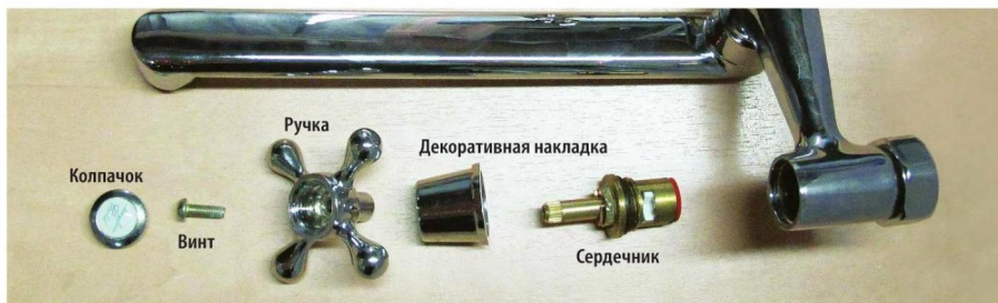
5 Для выкручивания сердцевины используют ключ для многогранников
