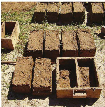
2 Размеры кирпича – 20 × 20 × 40 см. Форму можно сделать самостоятельно
