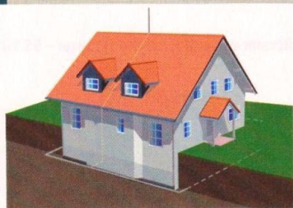
Металлический контур вокруг дома
