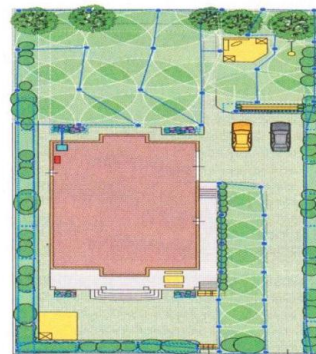
Схема полива должна включать план разводки, места установки дождевателей и зоны полива
