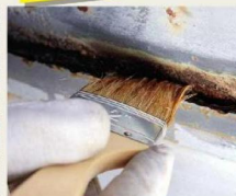
4 Ржавчину покрывают специальным преобразователем
