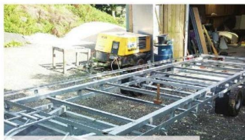
Металлическая транспортная база обеспечивает надежную основу для мобильного дома
