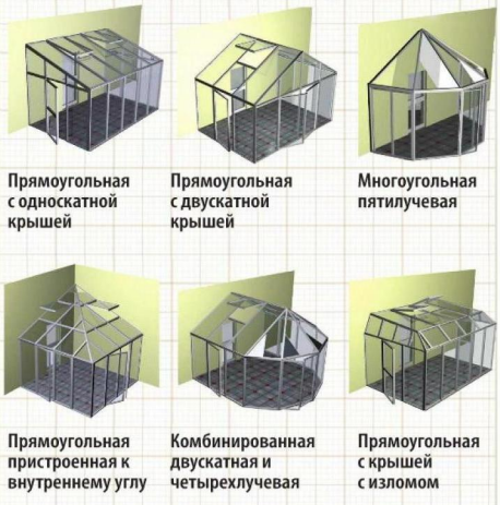
Алюминиевый каркас надежен, долговечен и обладает высокой несущей способностью
