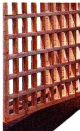
17 По периметру решётки шурупами крепят бруски рамы шириной 35 мм. Все рёбра деталей рамы скругляют галтельной фрезой.
