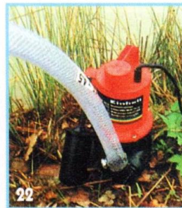
22 Двигатель всей системы – небольшой насос, установленный в пруду и подключённый к трубе для перекачки воды.
