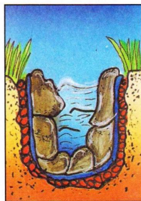
Рис. 4. На плёнку отсыпают землю или гравий, сажают растения, после чего пруд заполняют водой.
