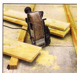
Рёбра среза следует со всех сторон слегка скруглить или притупить.
