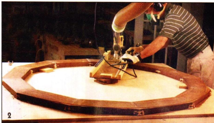
Внешнее кольцо столешницы вырезают из многогранной заготовки фрезерованием, установив фрезерную машинку в приспособление-циркуль.
