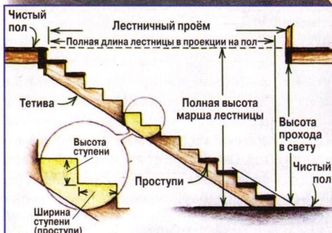
Рис. 1. Основные элементы одномаршевой лестницы.
