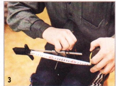
Выставив параллельный упор электролобзика на расстоянии 130 мм от пилки, зафиксировал его винтом.
