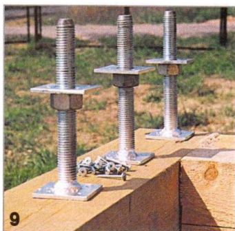
9 Оцинкованные домкраты. Чтобы их изготовить, автор приобрёл длинномерные шпильки с резьбой, напилит их по размеру, а затем приварил к стальным упорным пластинам. Плавную регулировку высоты стоек обеспечивают гайки и свободно надеваемые на стержни домкратов пластины.
