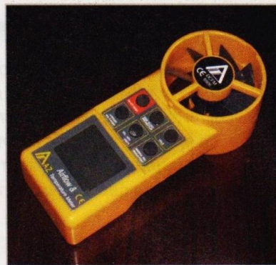
Все основные параметры циркулирующего воздуха, включая скорость его перемещения, легко измеряются специальным прибором.
