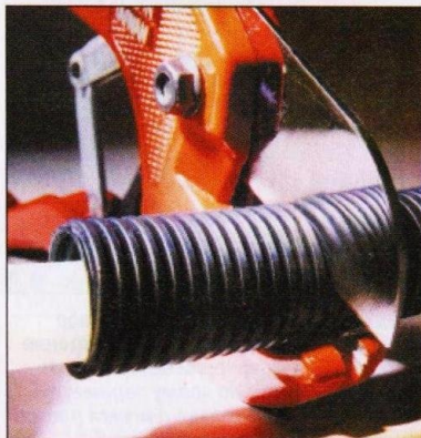
Для резки пластиковых труб и защитных гофрированных оболочек для них применяют специальные ножницы с широким лезвием.
