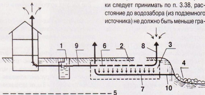
Рис. 4. Один из вариантов компоновочного решения автономной канализации с использованием песчано-гравийного фильтра: 1 — септик; 2 — засыпка фильтрующим грунтом; 3 — песчано-гравийный фильтр; 4 — каменная наброска; 5 — уровень грунтовых вод; 6 — оросительный трубопровод; 7 — сборный трубопровод; 8 — вентиляционный стояк; 9 — подводящий трубопровод; 10 — отводящий трубопровод.
