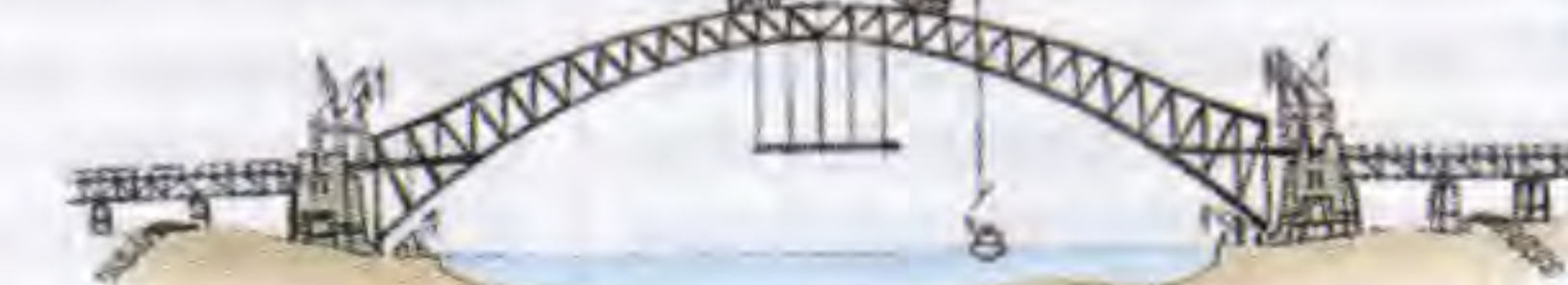
Возведение полотна моста
