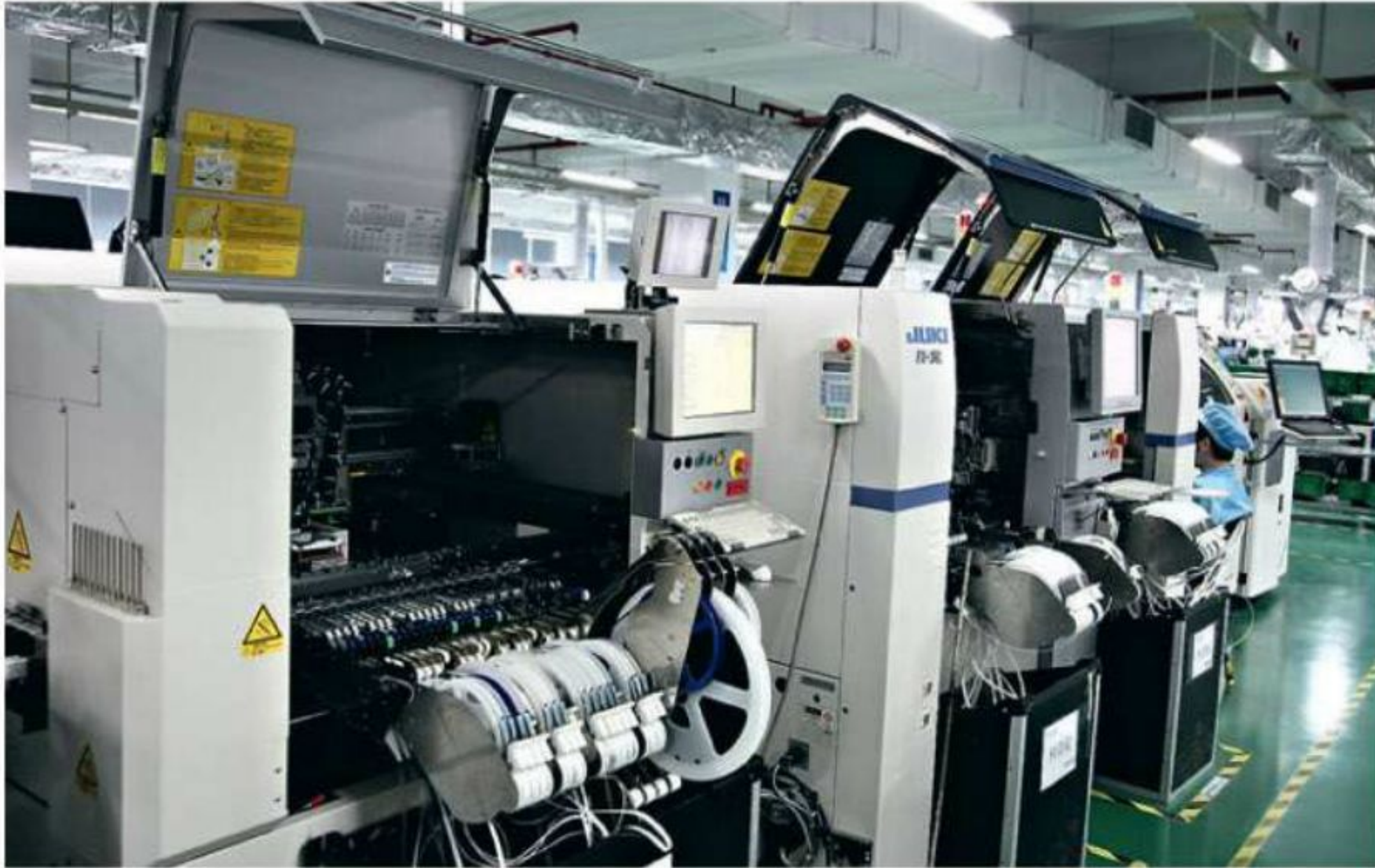
Гордость завода, монтажные аппараты Juki. Специально для нас кожухи открыты, но робот этого не замечает, работает, только и слышен тихий треск кареток, расставляющих детали
