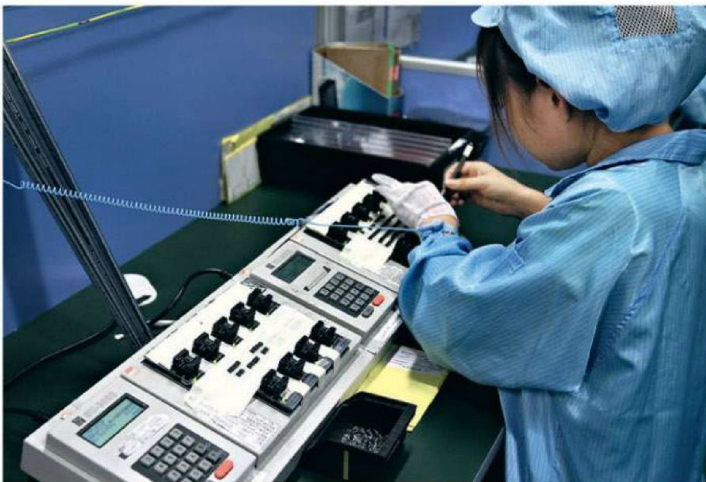
На таких стендах-программаторах производится заливка firmware в чипы памяти и сверка контрольной суммы с оригиналом. Зарядил пачку чипов в станок, пара секунд и готово!
