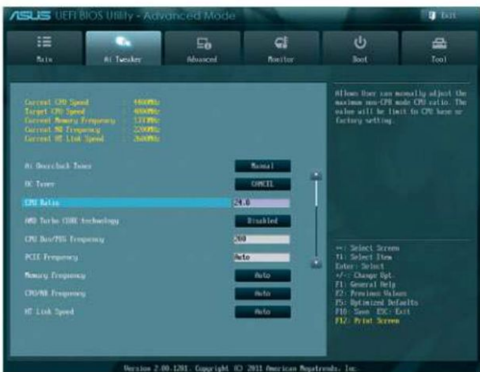
Частота ядер поднимается до 4,8 ГГц буквально парой взмахов мыши. AMD по доброй традиции не блокирует множитель
