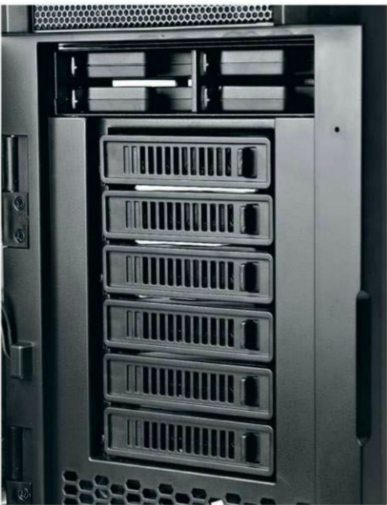
Xilence Interceptor PRO предлагает не менее 6 легкодоступных «посадочных мест» для HDD форм-фактора 3,5"
