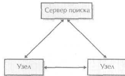
Рис. 1-3. Одноранговая архитектура с центральным сервером поиска
