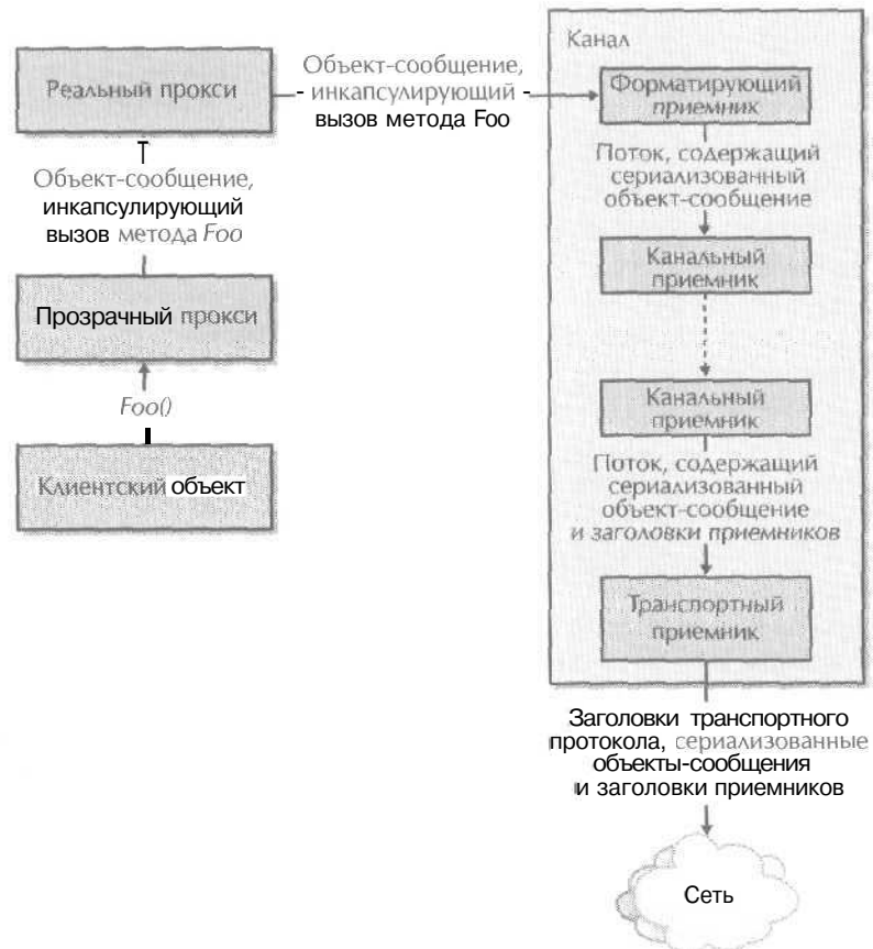
Рис. 2-9. Архитектура канала на стороне клиента
