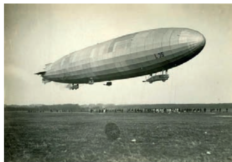
ZEPPELIN LZ-80 – германский дирижабль, толкаемый вперед шестью двигателями Maybach, развивал скорость до 103 км/ч
