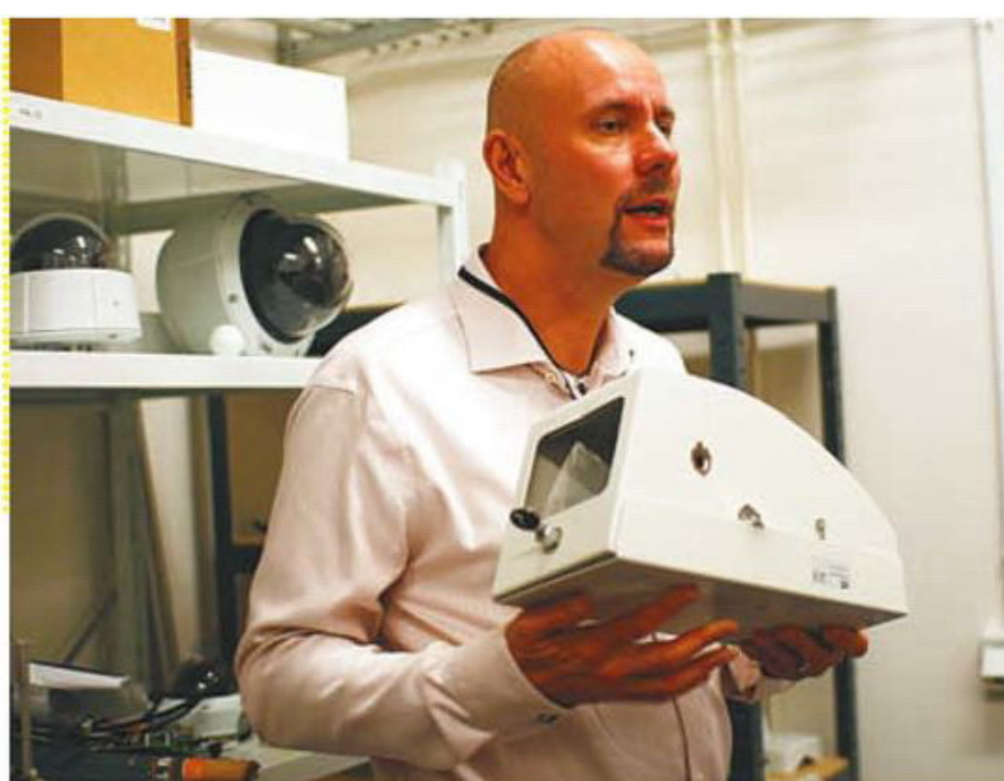
Пули не страшны Дэн Эрикссон демонстрирует корпус камеры после огнестрельного теста
