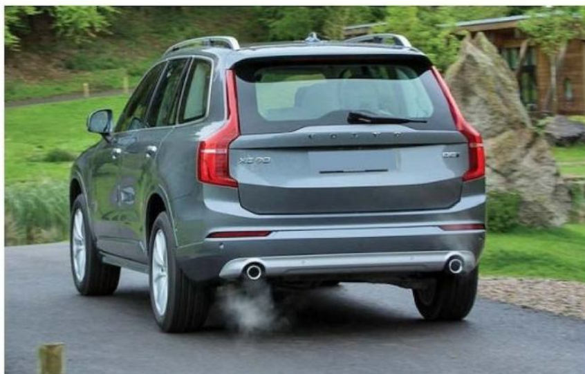
Узкие фонари XC90 размещены в стойках крыши
