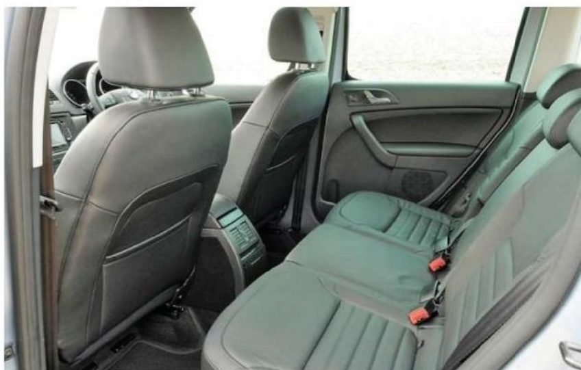
Задние сиденья Yeti оснащены горизонтальной регулировкой, изменяется и угол наклона их спинки
